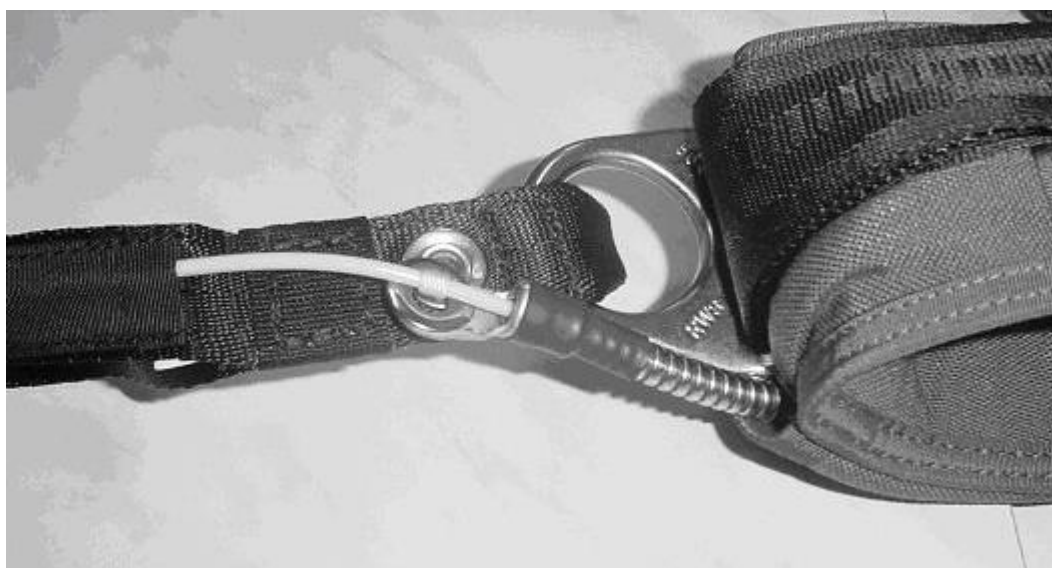
Pohled zespodu na zapojený volný konec nosného postroje
